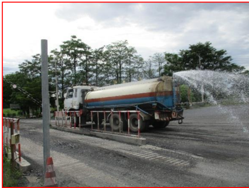
(19) การฉีดพรมน้ำเส้นทางขนส่งแร่
